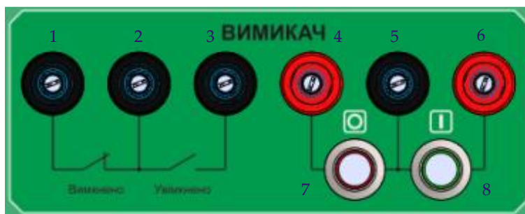
Малюнок 4. Органи управління, індикації та роз'єми для підключення зовнішніх зв'язків модуля імітатора вимикача.
