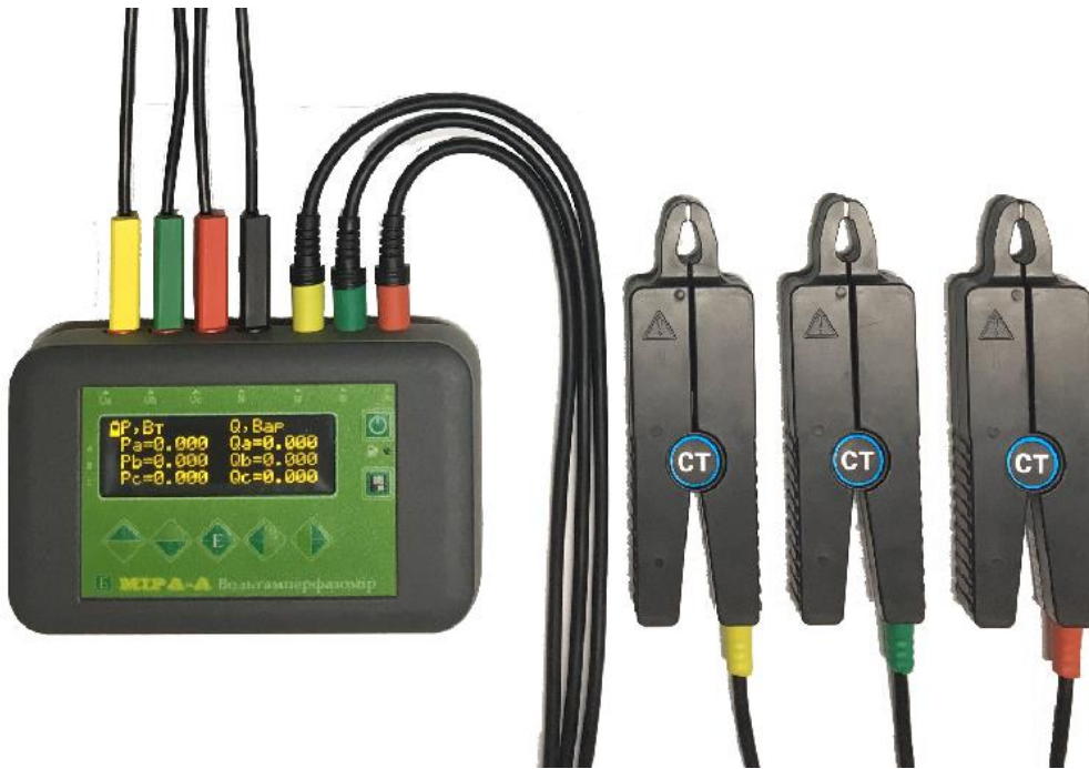
Малюнок 1. Зовнішній вигляд приладу з струмовимірювальними кліщами.
